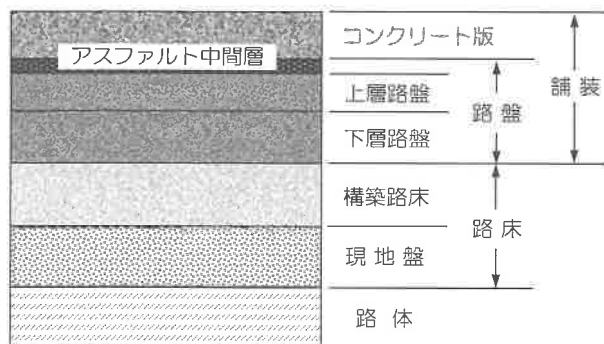
図1 一般的なコンクリート舗装の構成
