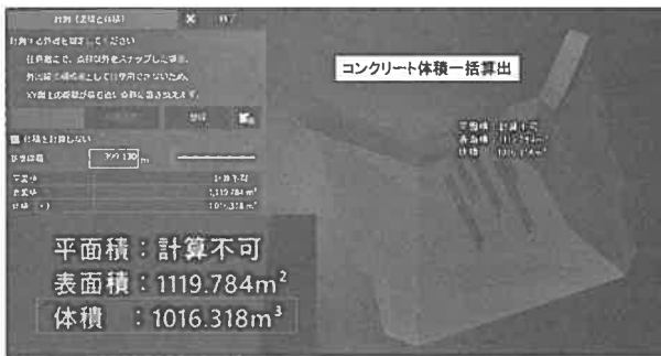
図-11 コンクリート体積一括算出
