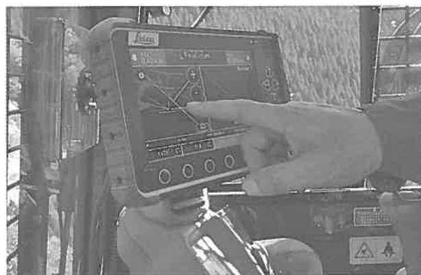
図-6 三次元モニターによる掘削箇所確認
