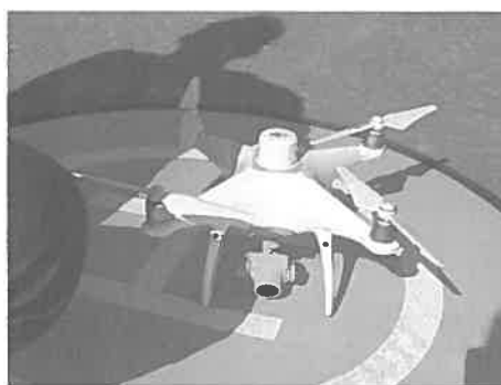
図5 RTK搭載ドローンによる高精度計測
