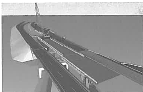
図-6 3次元モデル(仮橋設置)
