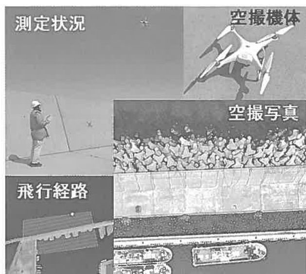
図-3 UAV測量実施状況
