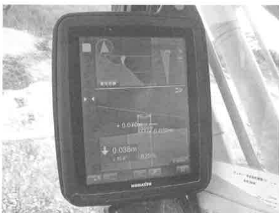
図-4 バックホウキャビン内モニター
