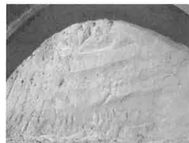
図-2 切羽地質状況 (壮瞥火砕流堆積物)
