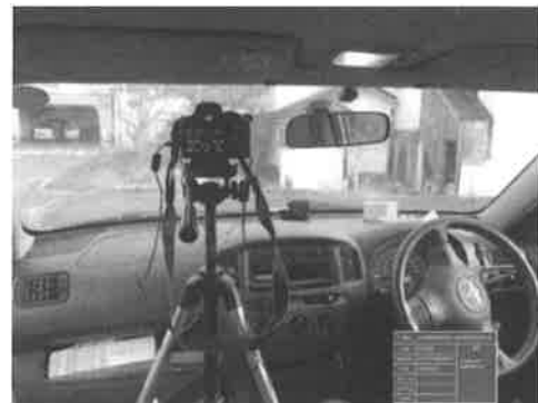
図-3 調査カメラ車載状況
