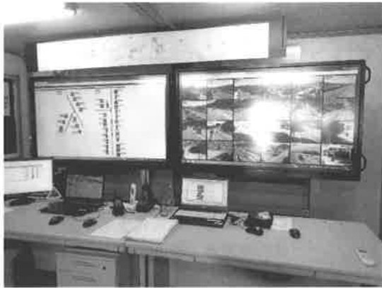
図-9 大型モニターによる安全対策としての一括モニタリング
