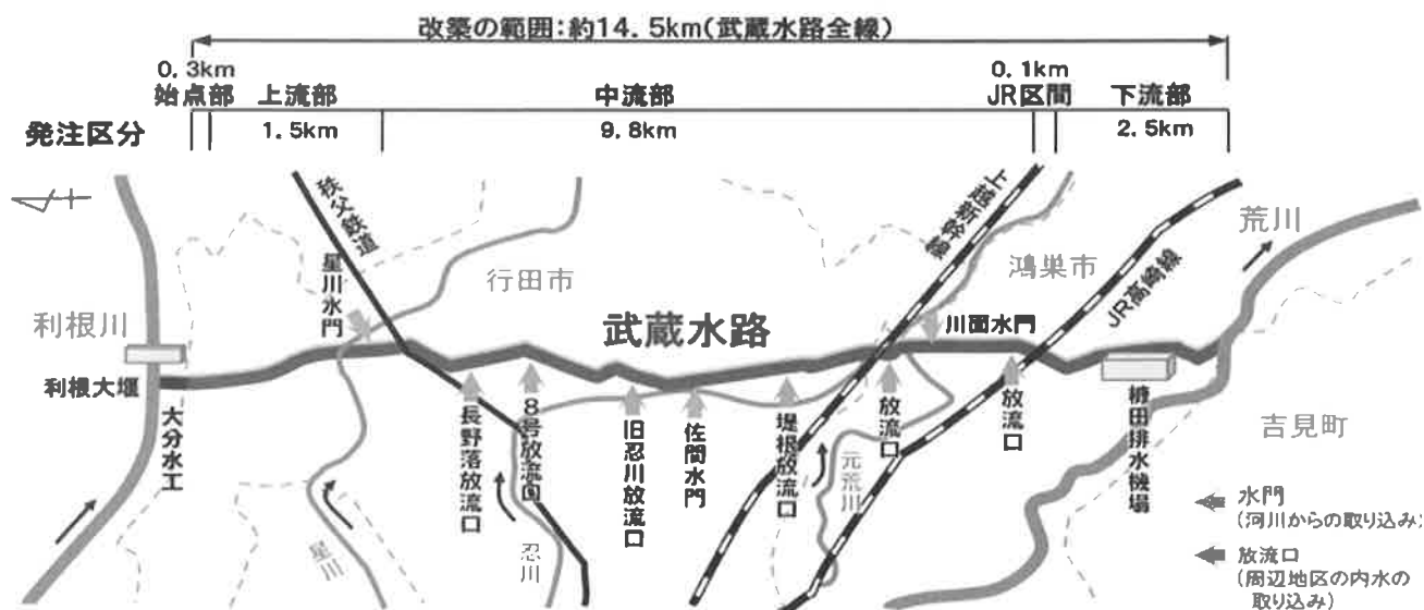
図-1 武蔵水路改築範囲
