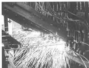
専門工場の点溶接機械により、 自動溶接
