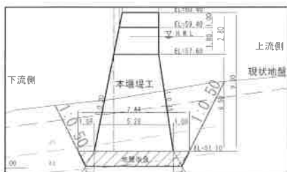
図-1 堰堤掘削断面図
