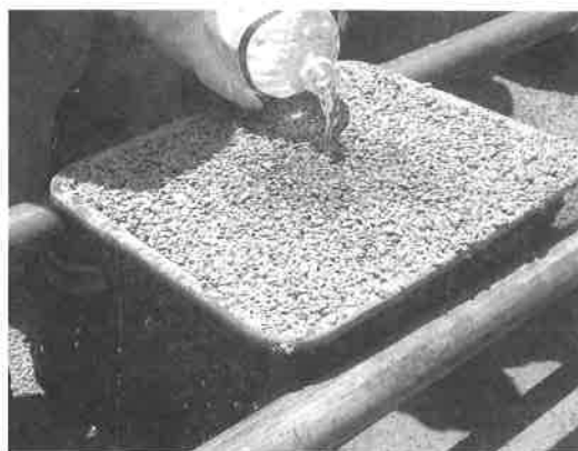
図－8 透水性コンクリート供試体
