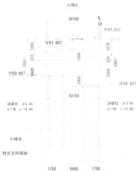
図-2 A1橋台構造図
