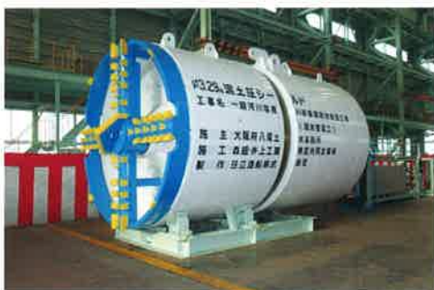
1268 朝倉 稔 『シールドマシン工場検査』
