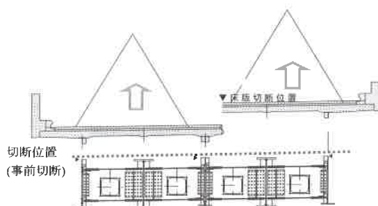
図-10 既設床版の分割撤去
