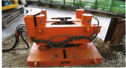
パイルプラー及び引抜き状況
